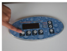
Panel de control digital de 25 funciones
